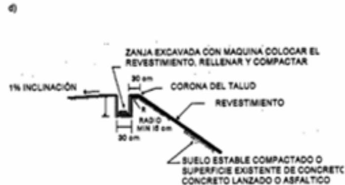
Figura 4.11 Esquemas típicos de anclaje de recubrimientos sintético
