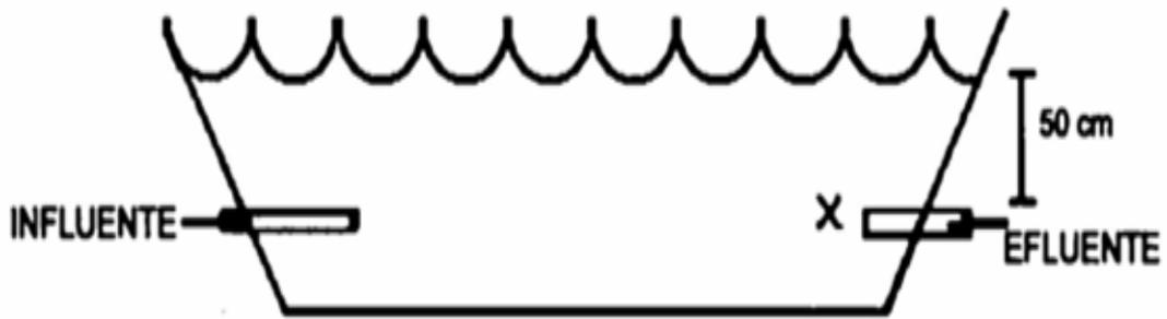
Figura 6.5 Localización de la toma de muestra en una laguna anaerobia
